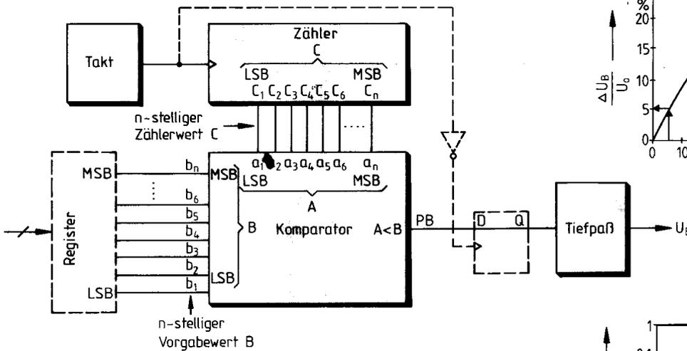
**Bild 2. n-Bit-Pulsbreitenmodulator als DAC**
