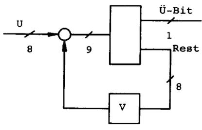
Bild 3. Das Prinzip des „Noise Shaping“: a) Signalfußplan; b) Algorithmus.
