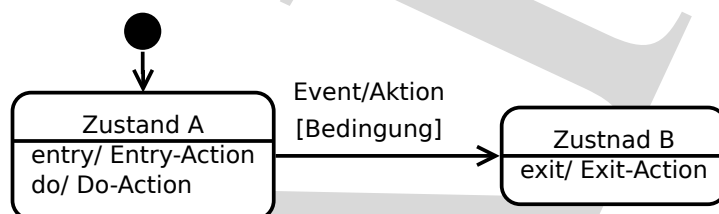
Abbildung 4.2: UML-Elemente eines Endlichen Automaten
