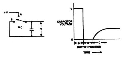
DIELECTRIC ABSORBTION CAUSES A BRIEFLY DISCHARGED CAPACITOR TO RECOVER A PERCENTAGE OF ITS PREVIOUS CHARGE ON BEING OPEN CIRCUITED.
