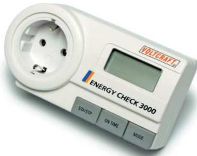
**Voltcraft Energy Check 3000: noch gute Genauigkeit bei unseren Testlasten, höchster Eigenverbrauch, empfindlich gegen induktive Einkopplung**
