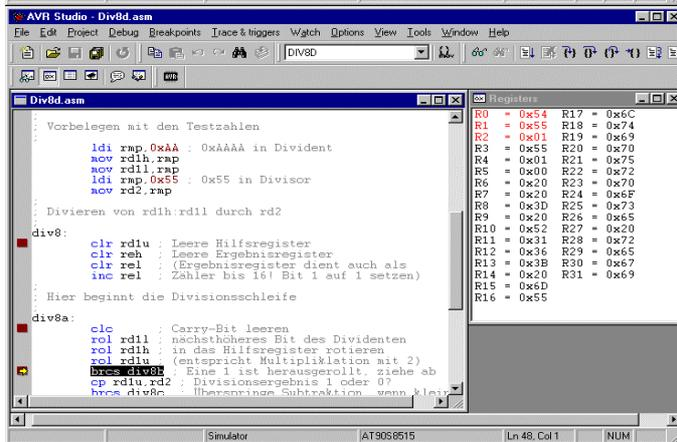
R1:R0 wurde nach links in Hilfsregister R2 geschoben, aus 0xAAAA ist 0x015554 entstanden.
