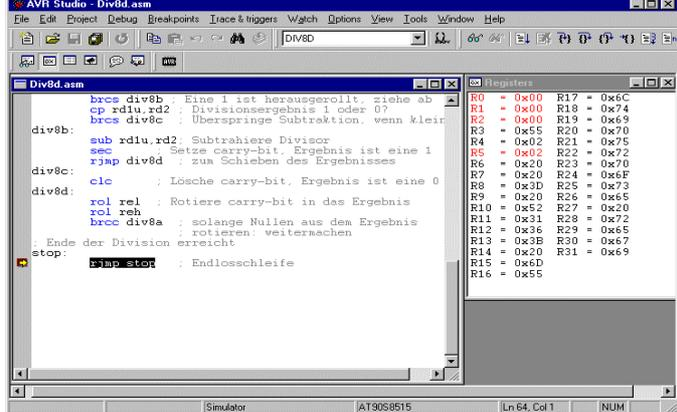
Nach dem 16-maligen Durchlaufen der Schleife gelangen wir schließlich an die Endloschleife am Ende der Division. Im Ergebnisregister R5:R4 steht nun das Ergebnis der Division von 0xAAAA durch 0x55, nämlich 0x0202.
