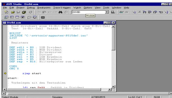
Die folgenden Bilder zeigen die Vorgänge im Simulator, dem Studio. Dazu wird der Quellcode assembliert und die Object-Datei in das Studio geladen.
