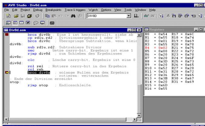
Weil 0x01 in R2 kleiner als 0x55 in R3 ist, wurde das Subtrahieren übersprungen, eine Null in das Carry gepackt und in R5:R4 geschoben. Aus der ursprünglichen 1 im Ergebnisregister R5:R4 ist durch das Linksrotieren 0x0002 geworden. Da eine Null in das Carry herausgeschoben wurde, geht der nächste Befehl (BRCC) mit einem Sprung zur Marke div8a und die Schleife wird wiederholt.
