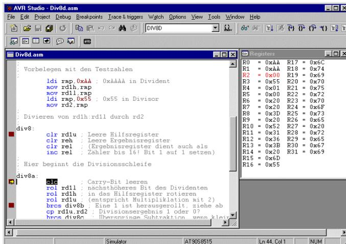
Die Startwerte für das Hilfsregister werden gesetzt, das Ergebnisregisterpaar wurde auf 0x0001 gesetzt.
