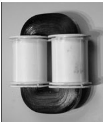
Bild 19 Rechteckiger Ringkern mit drehbaren Spulenkörpern
