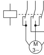
Reversieren eines Drehstrom-Motors
