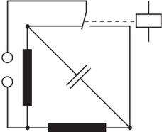
Reversieren eines Wechselstrom-Motors
