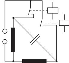
Reversieren eines Wechselstrom-Motors
