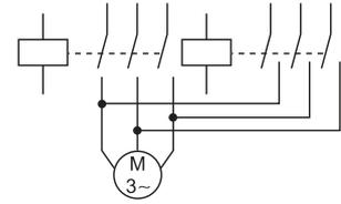
Reversieren eines Drehstrom-Motors
