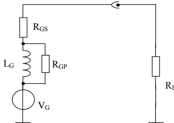
Fig.6: Equivalent circuit of the Dynamo ( $R_{GS} = 4\text{Ohm}$ ,  $L_G = 120\text{mH}$  und  $R_{GP} \approx 55\text{Ohm}$ )
