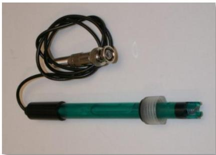
Über die BNC Buchse kann der pH Sensor angeschlossen werden. Der Sensor wird am besten an einer dunklen Stelle im Aquarium montiert, so muss er weniger von Algen befreit werden.
