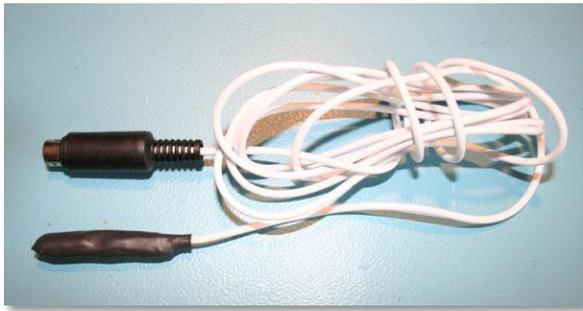
Der digitale Temperatursensor wird über den vierpoligen Stecker mit der Steuerung verbunden. Der Sensor ist wasserdicht und wird am besten in einer gut durchströmten Stelle im Aquarium platziert.
