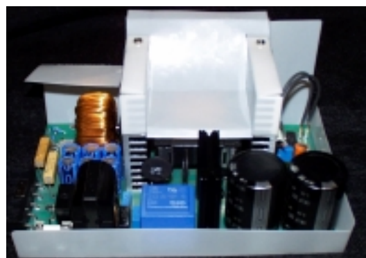
Abb. 22 Ausführung der Isolation- und Luftleitfolien
