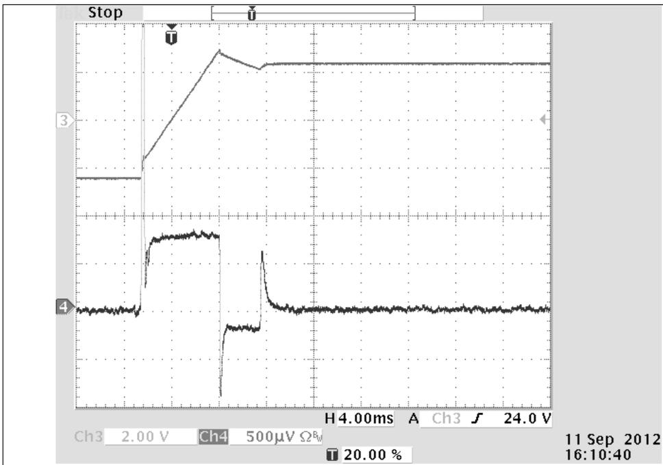
Bild 16: Detailaufnahme des Post-Regulatorsignals (Ausgangskondensator entfernt)
