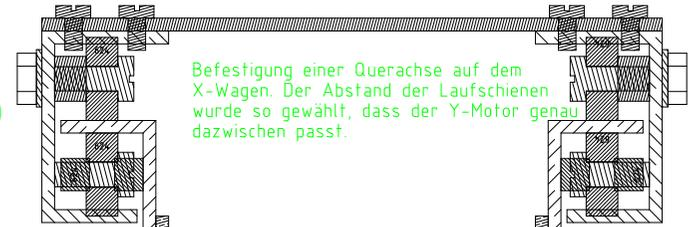
Befestigung einer Querachse auf dem X-Wagen. Der Abstand der Laufschienen wurde so gewählt, dass der Y-Motor genau dazwischen passt.
