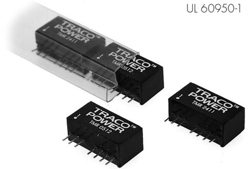
Die TMR 2 Serie bietet isolierte, regulierte 2 Watt DC/DC-Konverter mit einem weiten 2:1 Eingangsbereich. Diese Konverter im kompakten SIL-8 Gehäuse benötigen nur einen Platzbedarf von 2 cm<sup>2</sup> auf der Leiterkarte.
