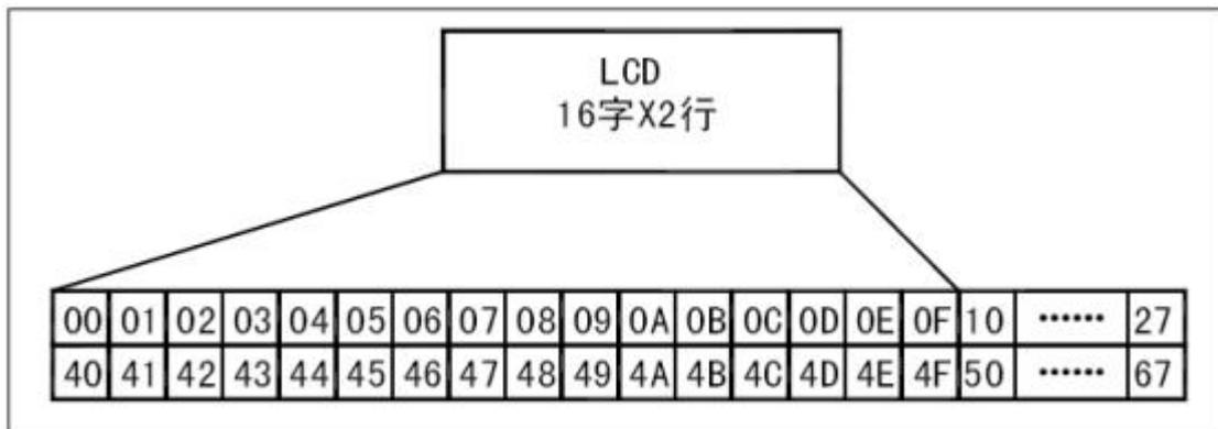
例如第二行第一个字符的地址是**40H**，那么是否直接写入**40H**就可以将光标定位在第二行第一个字符的位置呢？这样不行，因为写入显示地址时要求最高位**D7**恒定为高电平**1**所以实际写入的数据应该是**0100000B (40H) + 1000000B(80H)=1100000B(C0H)**。
