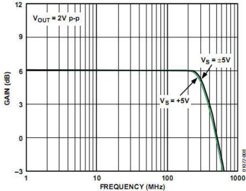
Bild 3: Frequenzgang AD8131 mit Abschluss  $> 200\Omega$
