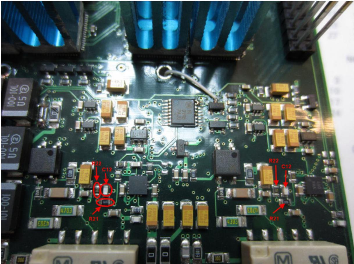
Bild 7: Rückkopplungszeitiges R<sub>21</sub> / R<sub>22</sub> / C<sub>12</sub>
