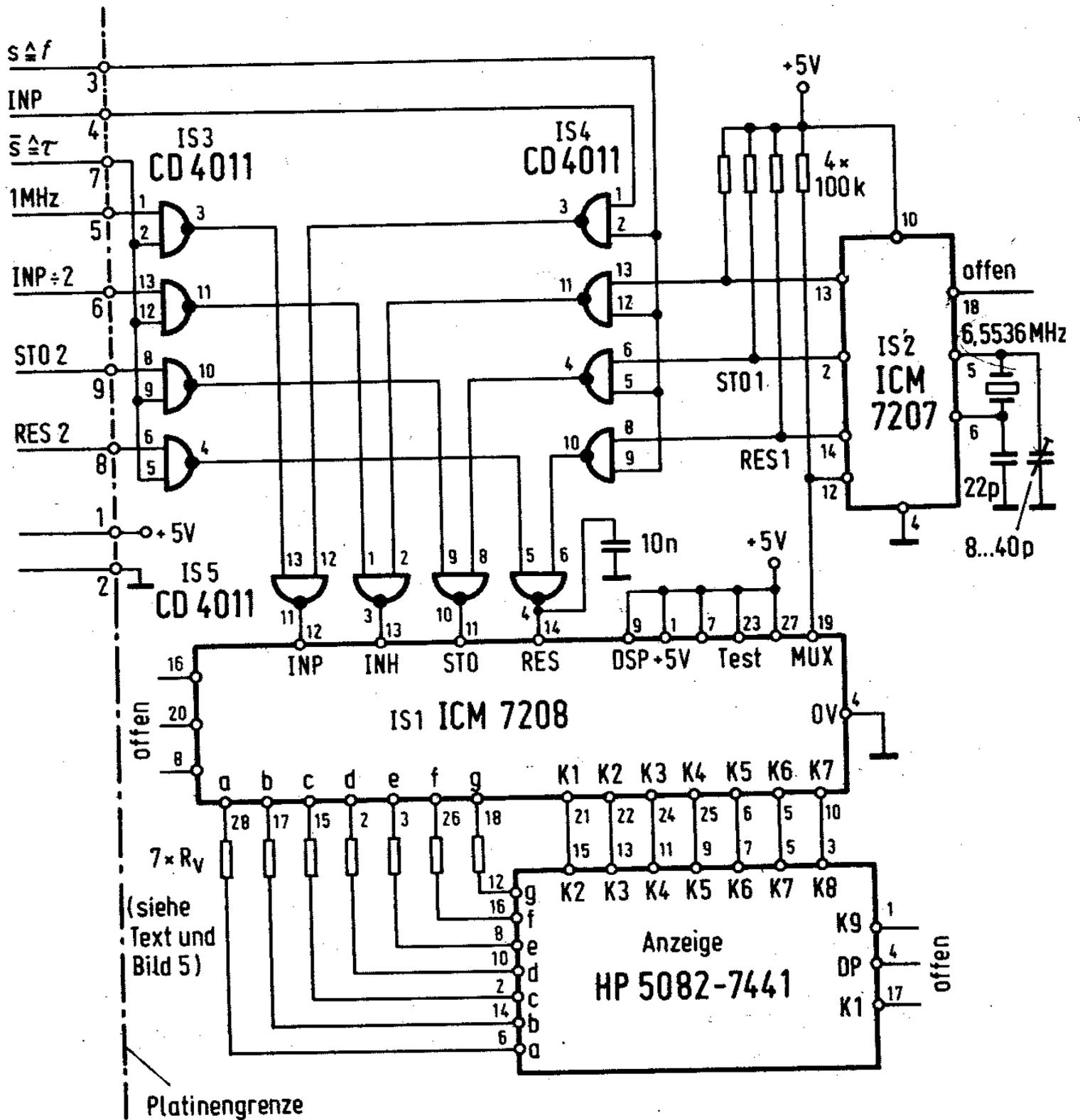
Bild 8. Schaltung des Frequenzzählers mit Umschalter für die Eingangssignale (Platine 1)
