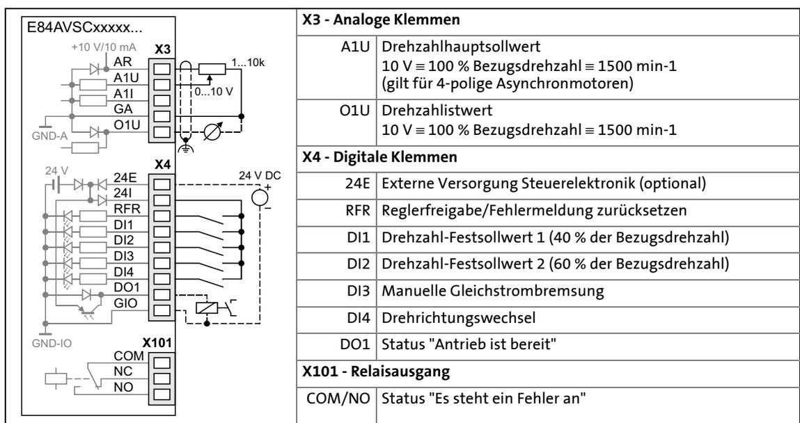
[4-2] Verdrahtung der Steueranschlüsse / vorkonfigurierte Belegung (Lenze-Einstellung)
