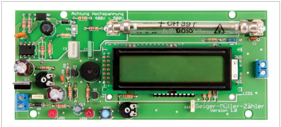
Bevor Sie mit der eigentlichen Montage beginnen, überprüfen Sie zuerst anhand der oben aufgeführten Stückliste, ob alle Bauelemente im Lieferumfang enthalten sind. Nach der Überprüfung der Stückliste sollten Sie zunächst mit der Montage der Bauteile beginnen, welche die niedrigsten Bauformen besitzen. Demzufolge sollte mit den Widerständen und den Transistoren begonnen werden. Danach fahren Sie mit den LEDs, den Elkos und der Anschlussklemme fort.
