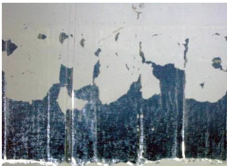
Bild 6: Folienmetallisierung, bei der eine starke Korrosion aufgetreten ist.
