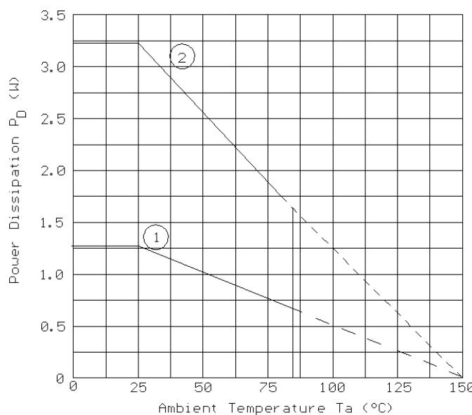
(1)  $R_{th(j-a)}$  IC only ( $96^\circ\text{C}/\text{W}$ )
