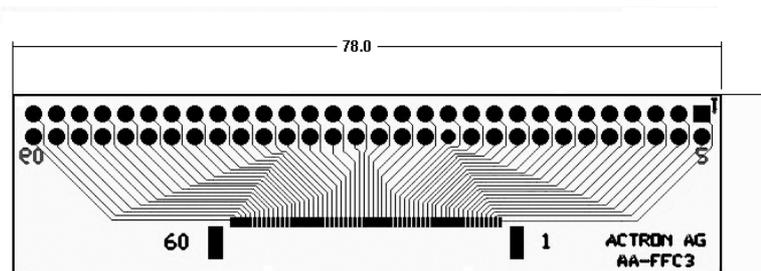
Es ist möglich die Platine für verschiedenste Displayarten einzusetzen, die über eine bis zu 60 polige FFC-Anschlussleitung im RM 0.5 mm verfügen.
