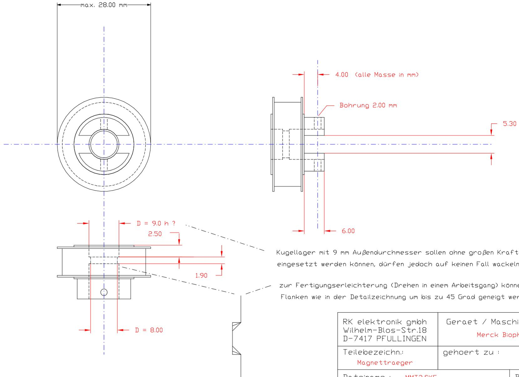
Kugellager mit 9 mm Außendurchmesser sollen ohne großen Kraftaufwand eingesetzt werden können, dürfen jedoch auf keinen Fall wackeln !
