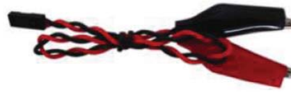
Kabel zur Motormessung (20 mm Länge)
