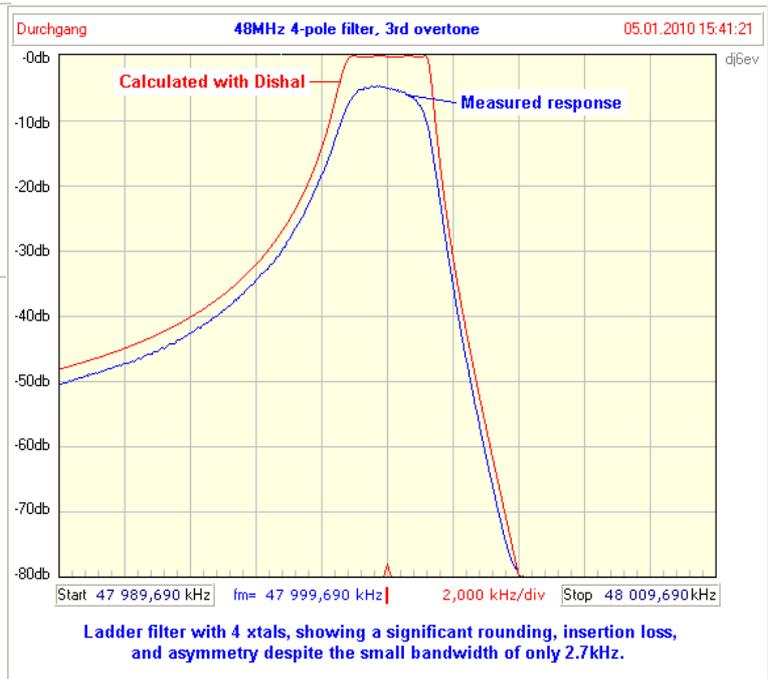
Da die starke Asymmetrie unerwünscht ist, wurde eine Vollkompensation mit 4 Parallelinduktivitäten  $L_p$  durchgeführt:
