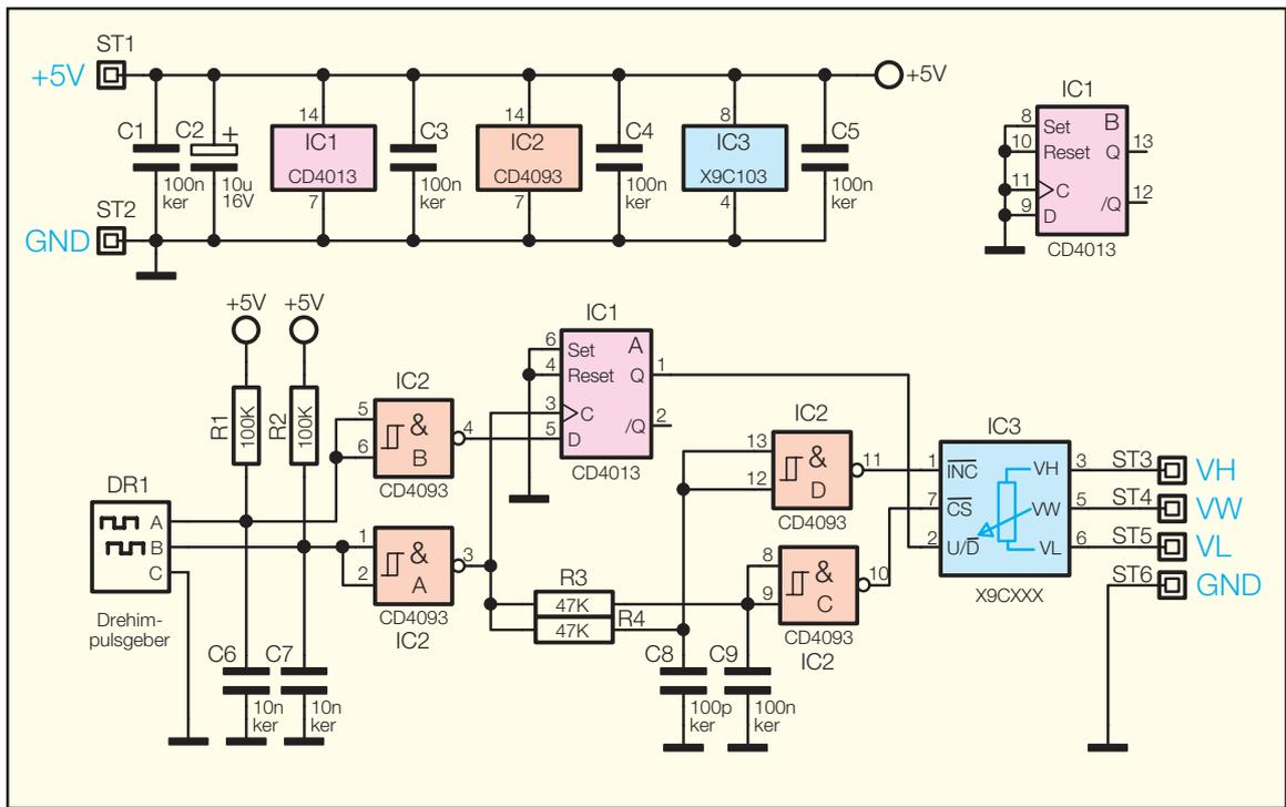
**Bild 5: Schaltbild des digitalen Potentiometers**
