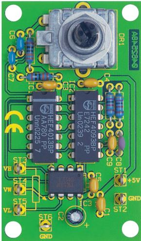
dort eingesetzt werden, wo ein elektromechanisches Potentiometer ersetzt werden soll. Es ist auch möglich, das digitale Poti z. B. in einem Rückkoppelnetzwerk eines Operationsverstärkers einzusetzen, mit dem dann der Verstärkungsfaktor einstellbar ist.
