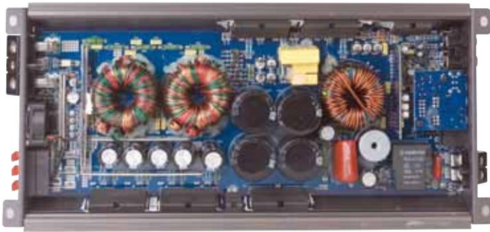
Der kleine digitale Monoblock besitzt ein üppiges Netzteil, um die geforderte Leistung sicherzustellen
