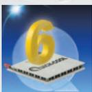
Reduziert man bei gleicher transportierter Wärmemenge die Temperaturdifferenz am Peltier-Element zwischen warm und kalt, so sinkt die benötigte elektrische Energie für den Wärmepump-Vorgang überproportional. Es ist unter Umständen sinnvoll, mehrere Elemente bzw. Kaskaden zu verwenden.
