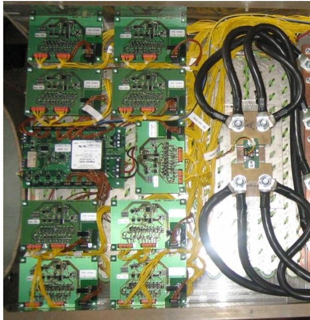
**Abbildung 2-5:** *Hardware des BMS der BMZ-Batterie*
