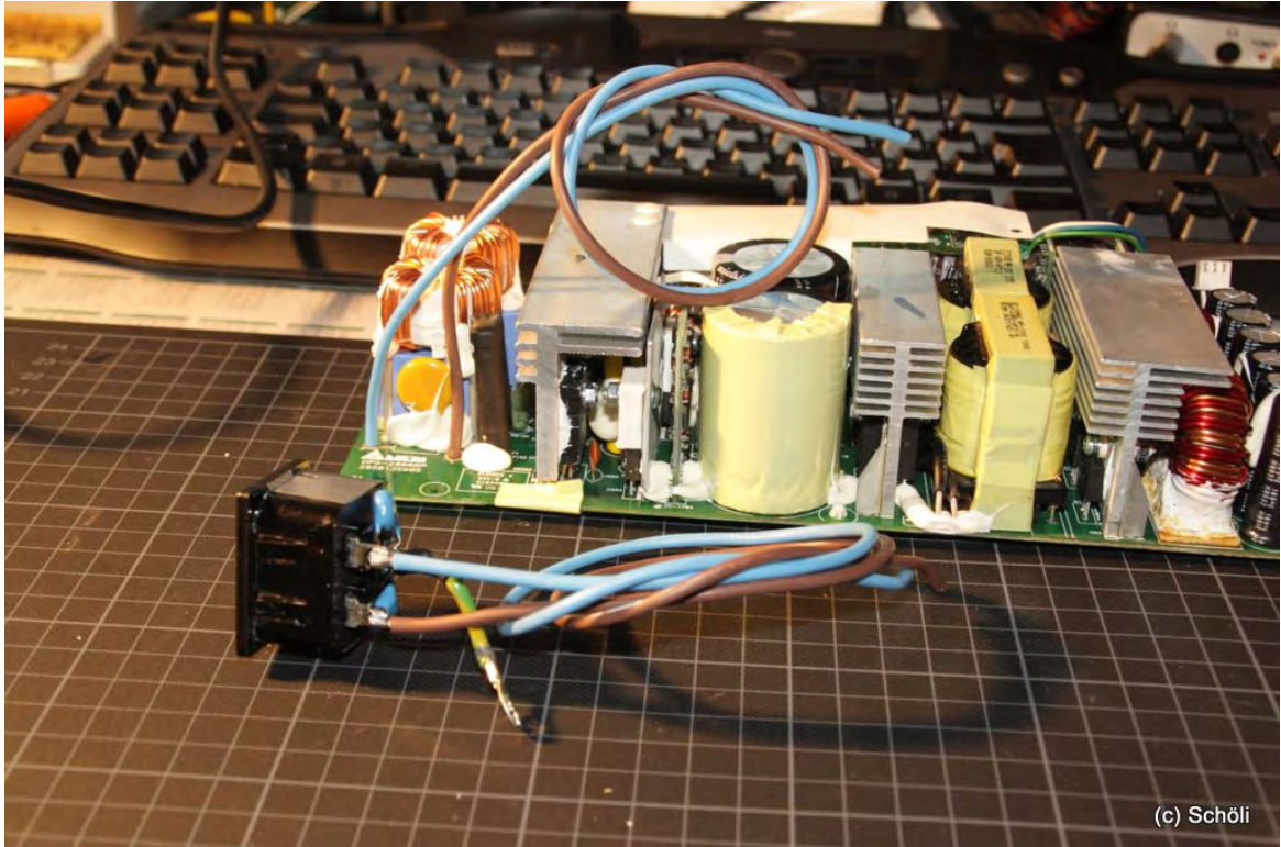
Bild 18: geänderte Verkabelung des Netzanschlusses
