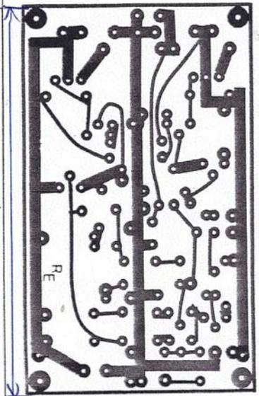
① Diskret aufgebaut: die vollständige Schaltung für einen schnellen Meß-Endverstärker mit 47-Ω-Ausgang
