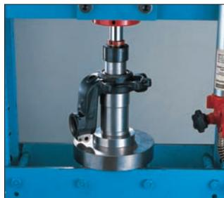
**11** Die Radnabe auf den Pressentisch plazieren. Den mit dem Lager bestückten Achsschenkelträger auf die Radnabe positionieren. Mit Hilfe eines Rohrs passenden Durchmessers, das sich in einwandfreiem Zustand befindet, auf den **Innenring** des Lagers Druck ausüben, bis das Lager sich in seiner Endposition befindet. Nie auf die Kodierdichtung drücken, um Beschädigungen zu vermeiden.
