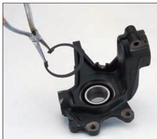
**7** Den Innenring und seinen Kugelreihe wieder in den Außenring einsetzen, der im Achsschenkelträger verblieben ist. Den Achsschenkelträger entweder auf ein Rohr oder auf Keile legen und unter der Presse positionieren. Mit Hilfe eines Rohrs passenden Durchmessers auf den Innenring des Radlagers Druck ausüben.
