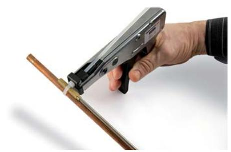
3) Den Kabelbinder Code 1209874AXX mit der Zange so lange festziehen, bis der Kabelbinder abgeschnitten ist.
