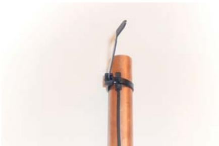
1) Enrouler le collier au tube et le fermer ;
