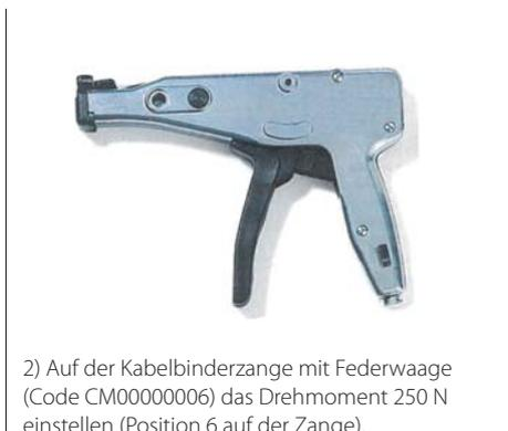
2) Auf der Kabelbinderzange mit Federwaage (Code CM00000006) das Drehmoment 250 N einstellen (Position 6 auf der Zange).
