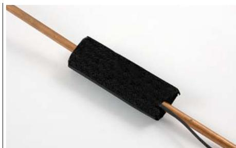
5) Den Fühler mit Isolierstoff für mindestens 10 cm an den Enden der Kappe und des gewickelten Kabels abdecken.
