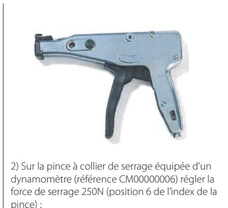
2) Sur la pince à collier de serrage équipée d'un dynamomètre (référence CM00000006) régler la force de serrage 250N (position 6 de l'index de la pince) ;
