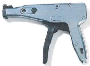
2) ur la pince à collier de serrage équipée d'un dynamomètre (référence CM00000006) régler la force de serrage 250N (position 6 de l'index de la pince) ;
