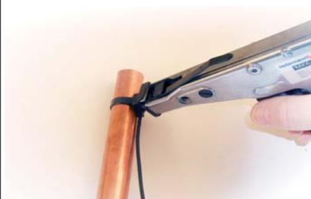
3) Den Kabelbinder mit der Zange so lange festziehen, bis der Kabelbinder abgeschnitten ist.
