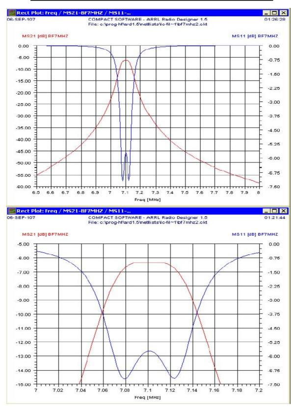
Wie man sehen kann, ist die Reflexionsdämpfung bei Flachkopplung nicht besonders gut (blaue Kurve). Wird nur besser, wenn man auf die schmale Bandbreite verzichtet und unterkritisch koppelt. (starke Verrundung statt Flat-Top und größere Bandbreite als Preis dafür)
