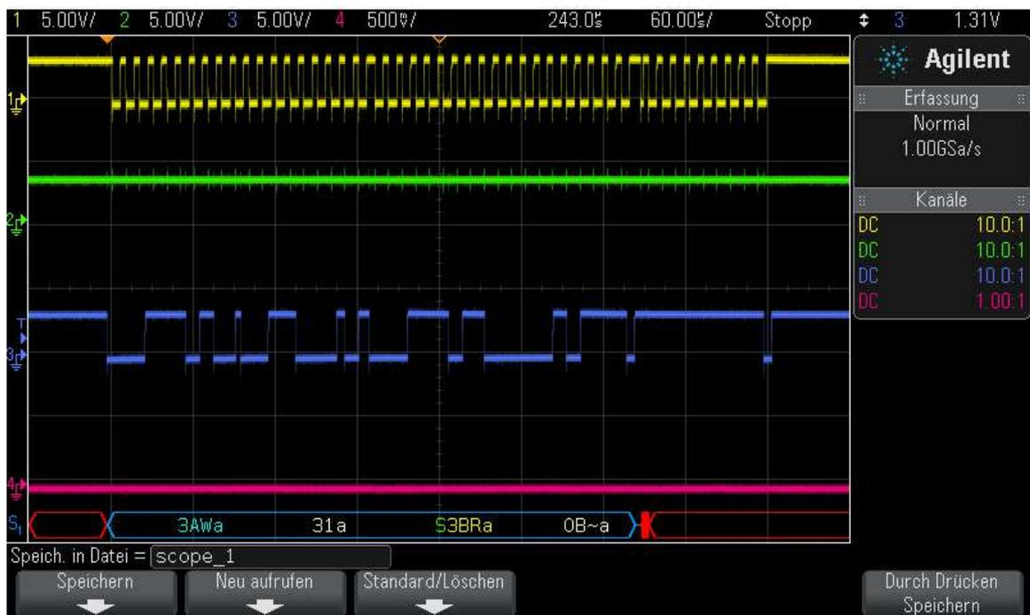
Abbildung 3.4: Lesen des Wertes im REG\_DATA\_FORMAT-Register, Eigene Darstellung
