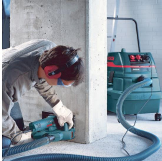
**Mauernutfräse mit Staubabsaugung**
