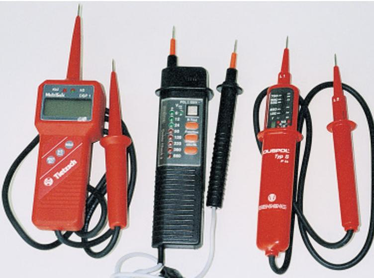
Zum Feststellen der Spannungsfreiheit an Niederspannungsanlagen sollte zweipoligen Geräten der Vorzug gegeben werden
