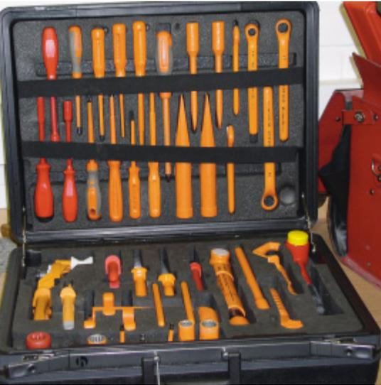
Werkzeugtasche mit isoliertem Werkzeug für Arbeiten an unter Spannung stehenden Teilen
