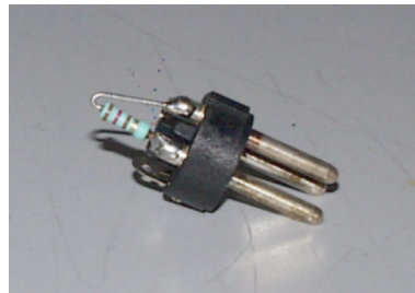
Das Innere eines XLR Abschlusssteckers
