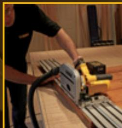
Innovative, mittig positionierte Maschinenführung erlaubt den Einsatz der Säge auf der Führungsschiene in beide Richtungen
