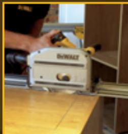
Integrierter Rückschlagstopp für sichere und kontrollierte Maschinenführung
