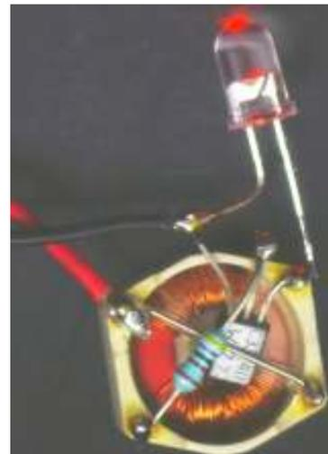
wer die Schaltung mit einer anderen Drossel als im Workshop bereitgestellt aufbaut, muss evt. die Wicklungen mit einem Ohmmeter oder Durchgangsprüfer identifizieren. Die Anschlüsse können vertauscht sein! Wenn die Schaltung nicht funktioniert, die Anschlüsse von 1 (egal welcher) Wicklung vertauschen. Wer will, kann R1 für besten Wirkungsgrad optimieren.
