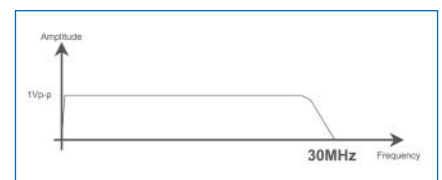
Bild 4: Videospektrum für HDTV.
