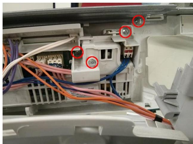
Abbildung 3: Blechblende lösen Teil 2 (Schraube oben rechts). Die übrigen Schrauben halten die Platine – lösen.
