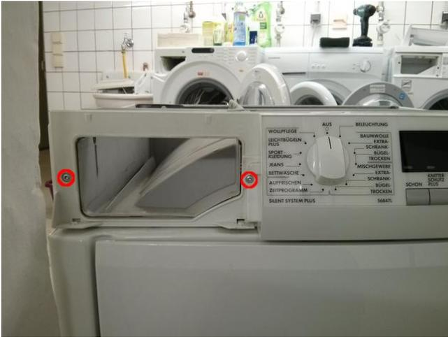
Abbildung 4: Kunststoffblende lösen
