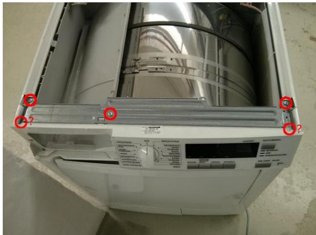
Abbildung 2: Blechblende lösen („?“ bedeutet: Schrauben lösen, wenn da welche sind)
