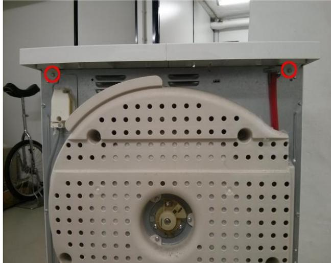
Abbildung 1: Deckelschrauben lösen
