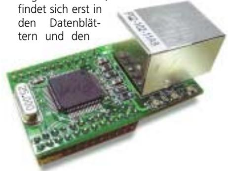
**Bild 3: 10/100 Mbit/s Ethernet-Modul IIM7010 mit W3100A und RTL8201L als PHY (49 x 25 mm)**
