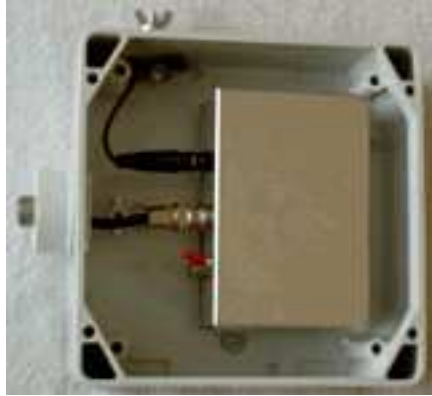
Abbildung 11: Aktivantenne in wasserdichter Verteilerdose
