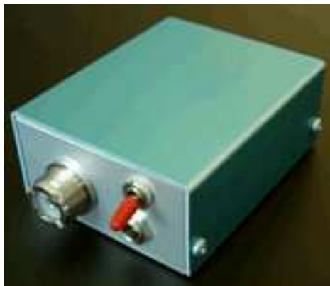
Abbildung 10: Die Fernspeiseweiche von Außen
