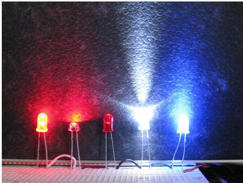
Bild 1: Vergleich von LEDs, I = 28 \text{ mA} , von links: rot diffus; rot \varphi=120^\circ ; rot Standard; weiß klar \varphi=20^\circ ; blau diffus
