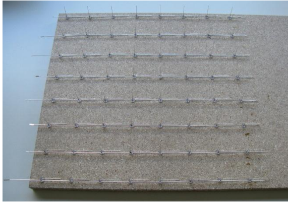
Bild 10: Verbindung der Anoden einer Reihe
