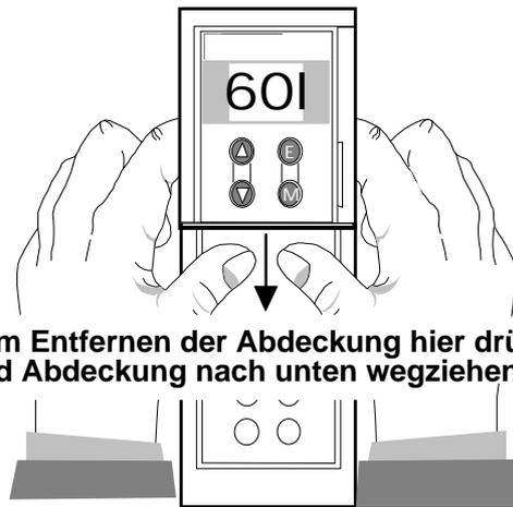
Zum Entfernen der Abdeckung hier drücken und Abdeckung nach unten wegziehen
