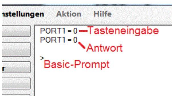
Ausführung des Befehls zu sehen. In der ersten Zeile der eingegebene Befehl, darunter die Antwort des Basic und zuletzt das Bereitschaftsprompt als Kennung, dass das Basic wieder bereit für neue Befehle ist.
