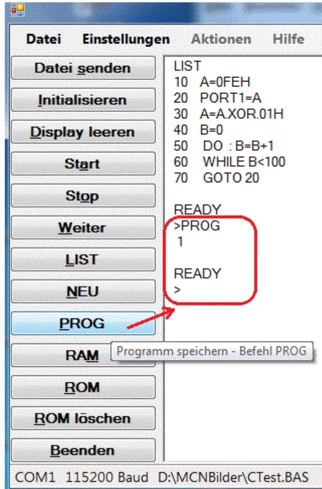
Es können mehrere Programme im Programmspeicher liegen. Beim abspeichern weist PROG jedem Programm eine fortlaufende Nummer zu. Unter dieser Nummer ist das Programm dann erreichbar. Im Beispiel wird das Programm unter der Nummer 1 gespeichert, das nächste Programm dann unter Nummer 2 usw.
