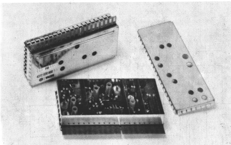
Der VALVO-Dioden-Tuner FD 11 ist für den Empfang von frequenzmodulierten Rundfunksendungen im UKW-Bereich von 87,5 bis 108 MHz eingerichtet. Seine Ausführung in Modul-Bauweise ist durch kompakte Abmessungen und Steckbarkeit aller elektrischen Anschlüsse gekennzeichnet.
