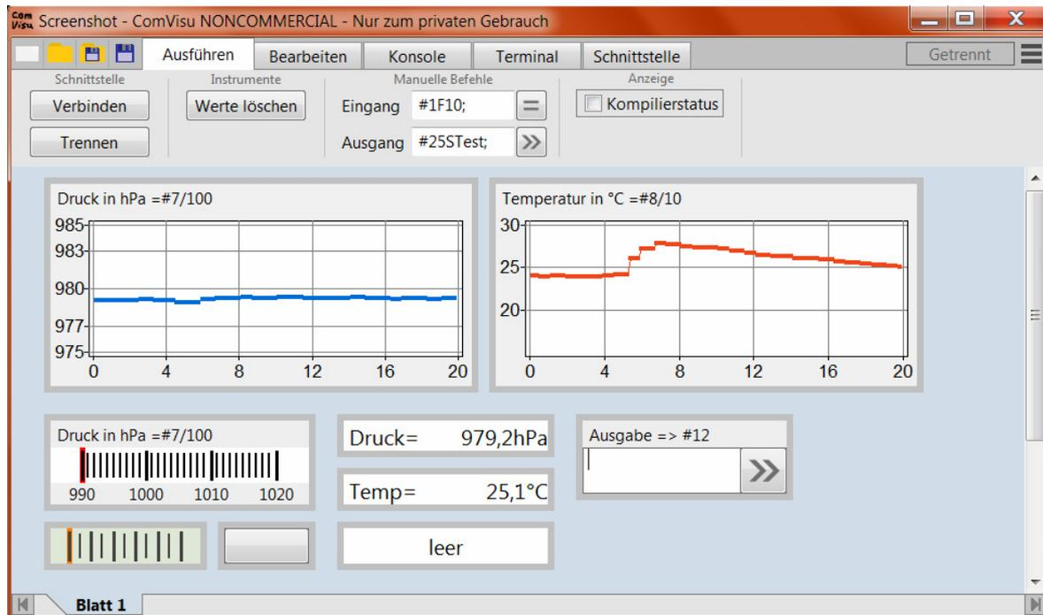
In der Bearbeitungsfläche werden Instrumente platziert und konfiguriert. Das blau hinterlegte Feld Eingang (bzw. Ausgang) im Eigenschafteneditor legt den Kanal fest, das Aussehen der Anzeigen kann weitgehend dem eigenen Bedarf angepasst werden.
