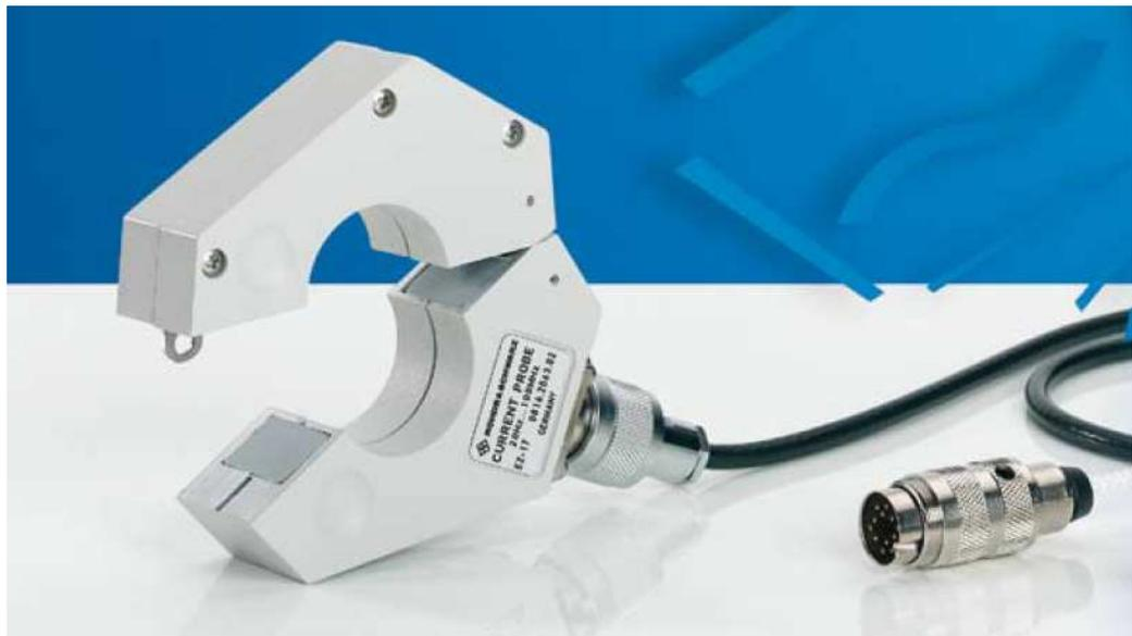
Fig. 3-3: Geeignet für die Messung von Störströmen ist beispielsweise die Stromzange R&S®EZ-17 mit 10dB (Modell 02) bzw. 17 dB (Modell 03) Transferimpedanz und 100 MHz Bandbreite. Ein großer Innendurchmesser von 30 mm ermöglicht die Messung an Kabelbündeln
