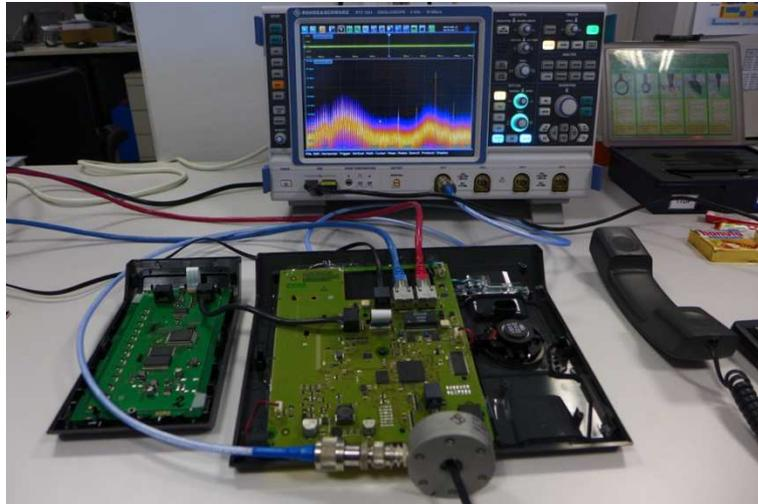
Fig. 4-13: Störstrommessung auf der Handapparateleitung
