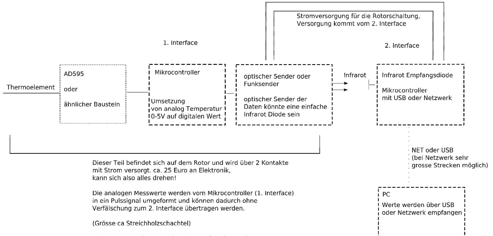
Dieser Teil befindet sich auf dem Rotor und wird über 2 Kontakte mit Strom versorgt. ca. 25 Euro an Elektronik, kann sich also alles drehen!
